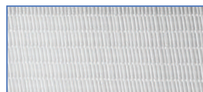
Medium-Filter (Class F8) (Option) มีประสิทธิภาพในการกรองฝุ่นละออง ขนาดตั้งแต่ 0.3-1.0 ไมครอน ถึง 98% โดยเฉลี่ย
